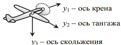
Рисунок 2 – Самолётные оси
